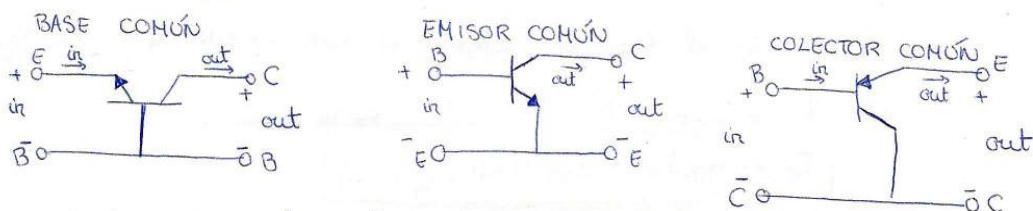
A la hora de analizar el transistor, escogemos como variables independientes la corriente de entrada y la tensión de salida, y como variables dependientes la tensión de entrada y la corriente de salida.
