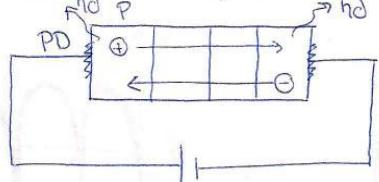
El exceso de huecos  $h_d$  se recombinan con el exceso de electrones del lado n, y b hacer radiativamente
