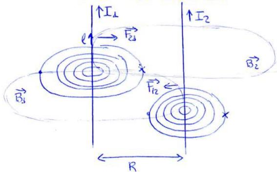
La corriente  $I_1$  induce  $\vec{B}_1$  y la corriente  $I_2$  induce  $\vec{B}_2$ .
