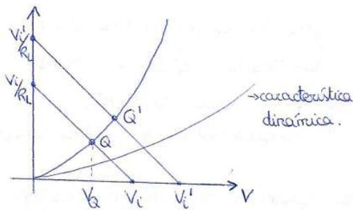
Si  $V_i$  depende de  $t \Rightarrow Q(t)$  es un punto de trabajo dinámico, tenemos una recta de carga dinámica y valores instantáneos.
