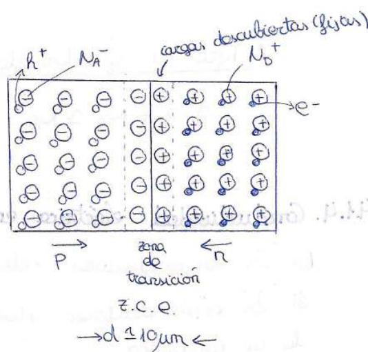
Cuando está en crecimiento, hay una gran cantidad de huecos a la izquierda y de electrones a la derecha, que tienden a juntarse para estabilizarse. Esto crea una corriente de difusión hacia la derecha. Aparecerá una distribución de carga e inmediatamente un campo eléctrico. El sistema deja de ser neutro
