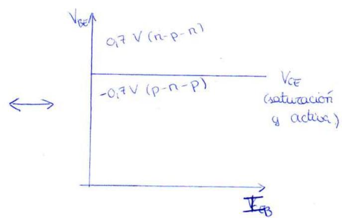
$$\begin{aligned} V_{CE} &= 0,2 \text{ V } (\text{n-p-n}) \\ V_{CE} &= -0,2 \text{ V } (\text{p-n-p}) \end{aligned} \quad \left. \begin{array}{l} \text{b} \\ \text{V}_{CB} \text{ todavía no está en PI} \rightarrow \text{modelo de codo} \end{array} \right.$$
