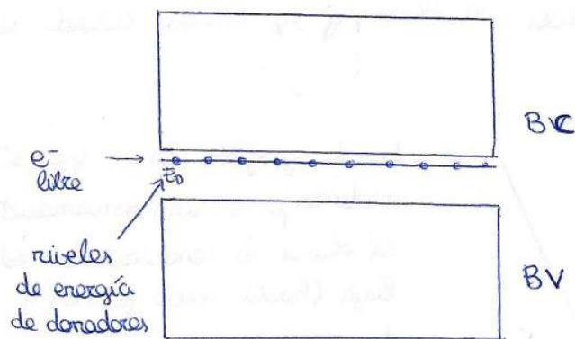
Cuando la temperatura sube, el 5º electrón que está en  $E_v$  salta a BC, lo que se conoce como salto extrínseco. El salto intrínseco es cuando el electrón pasa de la banda de valencia a la banda de conducción.
