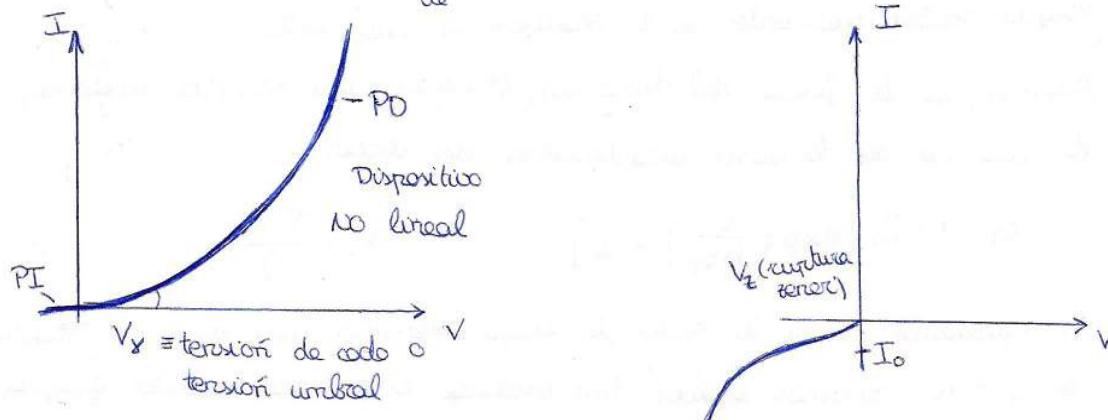
• Diodo de Ge -  $I_0 \approx 1 \mu A$  (Tamb),  $V_x = 0,2 \text{ V}$
