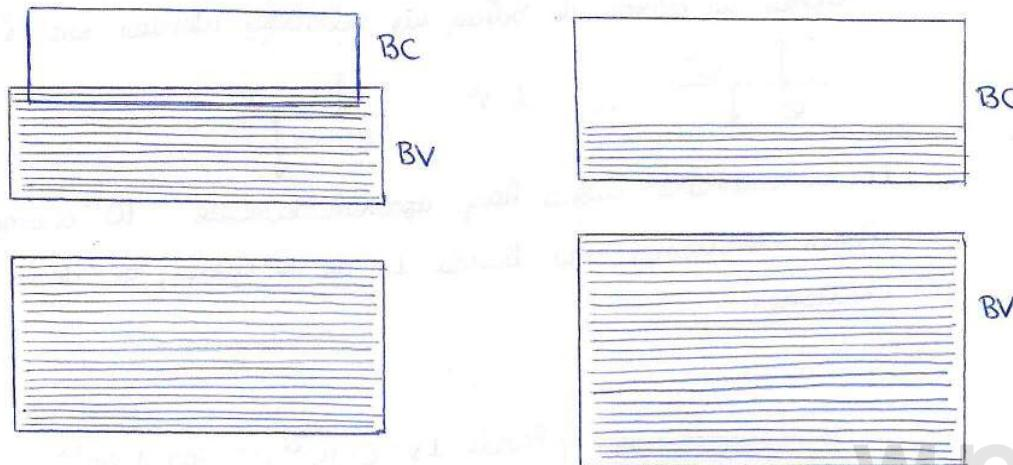
La banda de conducción está parcialmente ocupada, es el caso del silicio (Si) o el plomo (Pb), ambos pertenecientes al grupo IV. Bajo un campo eléctrico estos materiales conducen debido a que los electrones de la banda de conducción pueden adquirir energía (pasar de estar en reposo a moverse) y saltar de nivel.
