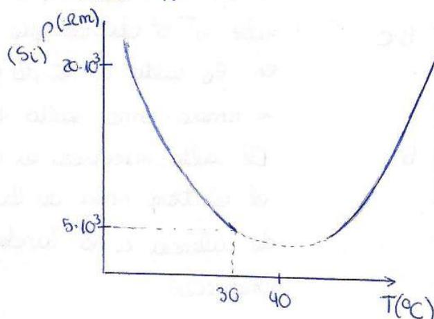
En la gráfica vemos que si medimos  $\rho$  en un semiconductor, al elevar la temperatura ésta baja (hasta cierto punto), y después vuelve a subir cuando más se eleva la temperatura (antes de fundirse)
