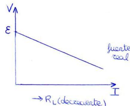
Hay dos parámetros que caracterizan la fuente: la fem (\$E\$) y la resistencia interna de la fuente (\$r\$)
