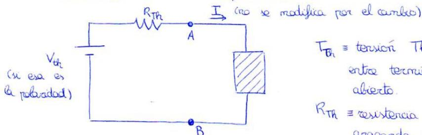
$V_{th}$  = tensión Thévenin, es la ddp entre terminales en circuito abierto.
