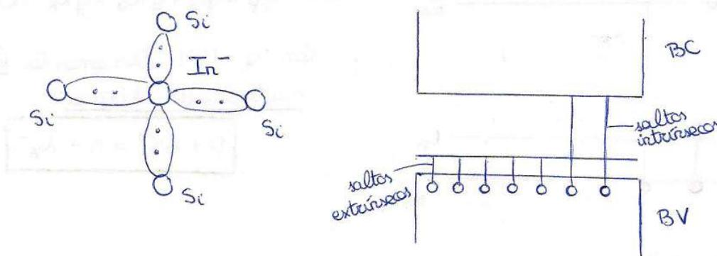
Este tipo de materiales tiene una gran cantidad de huecos en la banda de valencia y pocos  $e^-$  en la banda de conducción. Se llaman de tipo p porque transportan por cargas positivas, en la fórmula  $\sigma = q(n_p \mu_e + p_p \mu_h)$  el término  $n_p \mu_e$  es despreciable ( $n_p \ll p_p$ )
