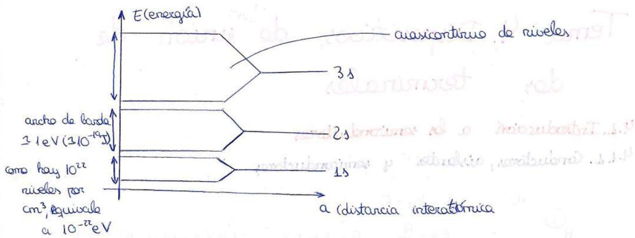
Si nos fijamos en el diagrama de bandas, tenemos bandas de energía permitidas y bandas de energía prohibidas.
