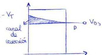
Si  $V_{DS}$  aumenta mucho, el canal desaparece.
