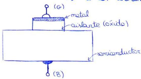
Se comporta como un condensador de placas planoparalelas. Se pueden poner dos tensiones: positiva y negativa.
