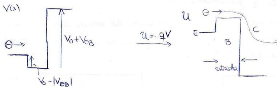
Aunque sólo una de las uniones está directamente polarizada, debido a la estructura del transistor, los iones se moverán a través de las dos uniones PN, habrá corriente en ambas uniones.
