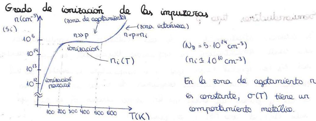
En la zona de agotamiento  $n$  es constante,  $\sigma(T)$  tiene un comportamiento metálico.
