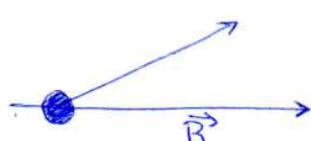
$$\vec{F} = q \cdot \vec{v} \times \vec{B} \quad \vec{F} \perp \vec{v}, \quad \vec{F} \perp \vec{B}$$
