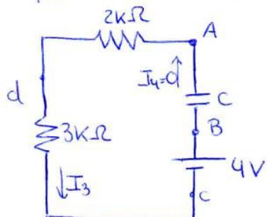
$$\begin{aligned} (V_A - V_B) + (V_B - V_C) + (V_C - V_D) + (V_D - V_A) &= 0 \\ (V_A - V_B) + 4 - I_3 \cdot 3 - I_4 \cdot 2 &= 0 \\ (V_A - V_B) = 0,4 \cdot 3 - 4 &= -2,8 \text{ V} \end{aligned}$$
