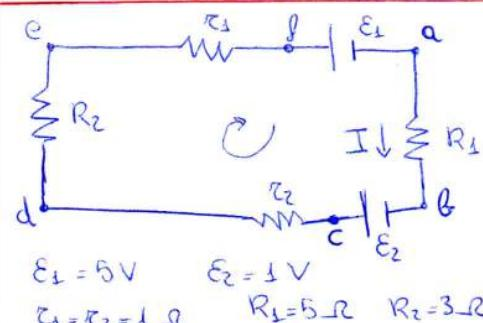
$$0 = (V_a - V_b) + (V_b - V_c) + (V_c - V_d) + (V_d - V_e) + (V_e - V_f) + (V_f - V_a)$$
